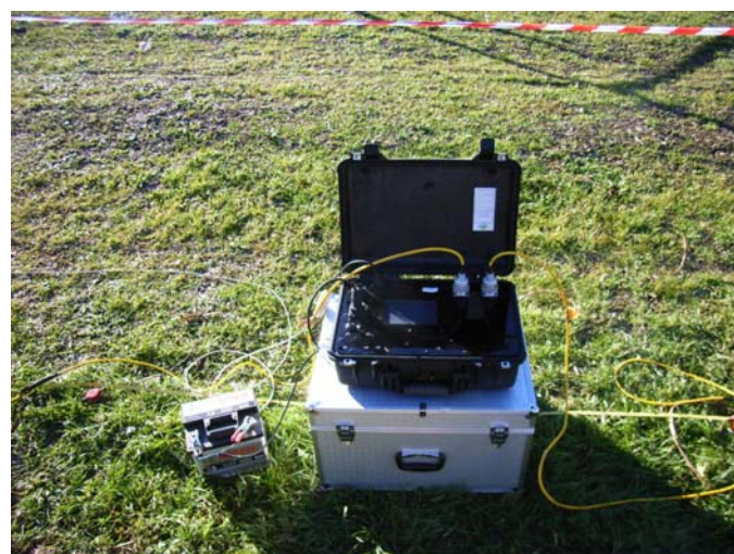
Stendimento sismico MASW lungo il campo sportivo. Sullo sfondo il comparto R3.1A.
