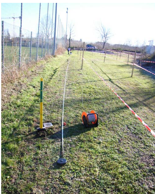
Stendimento sismico MASW lungo il campo sportivo. Sullo sfondo il comparto R3.1A.
