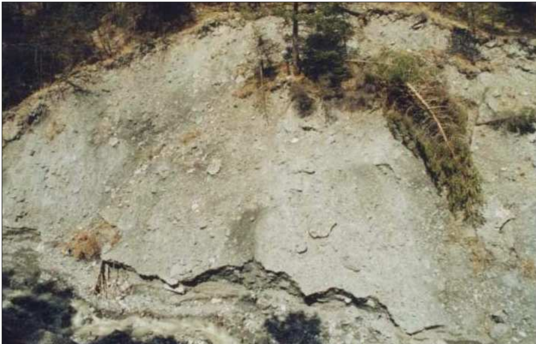
Frana per erosione di sponda in depositi detritico-glaciali in ambiente di Calcescisti e rocce carbonatiche
