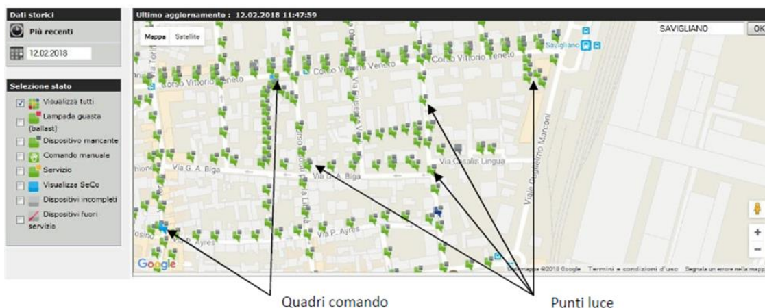
Figura 6. Schermata dal software per il telecontrollo e la telegestione. (Fonte: Comune di Savigliano)
